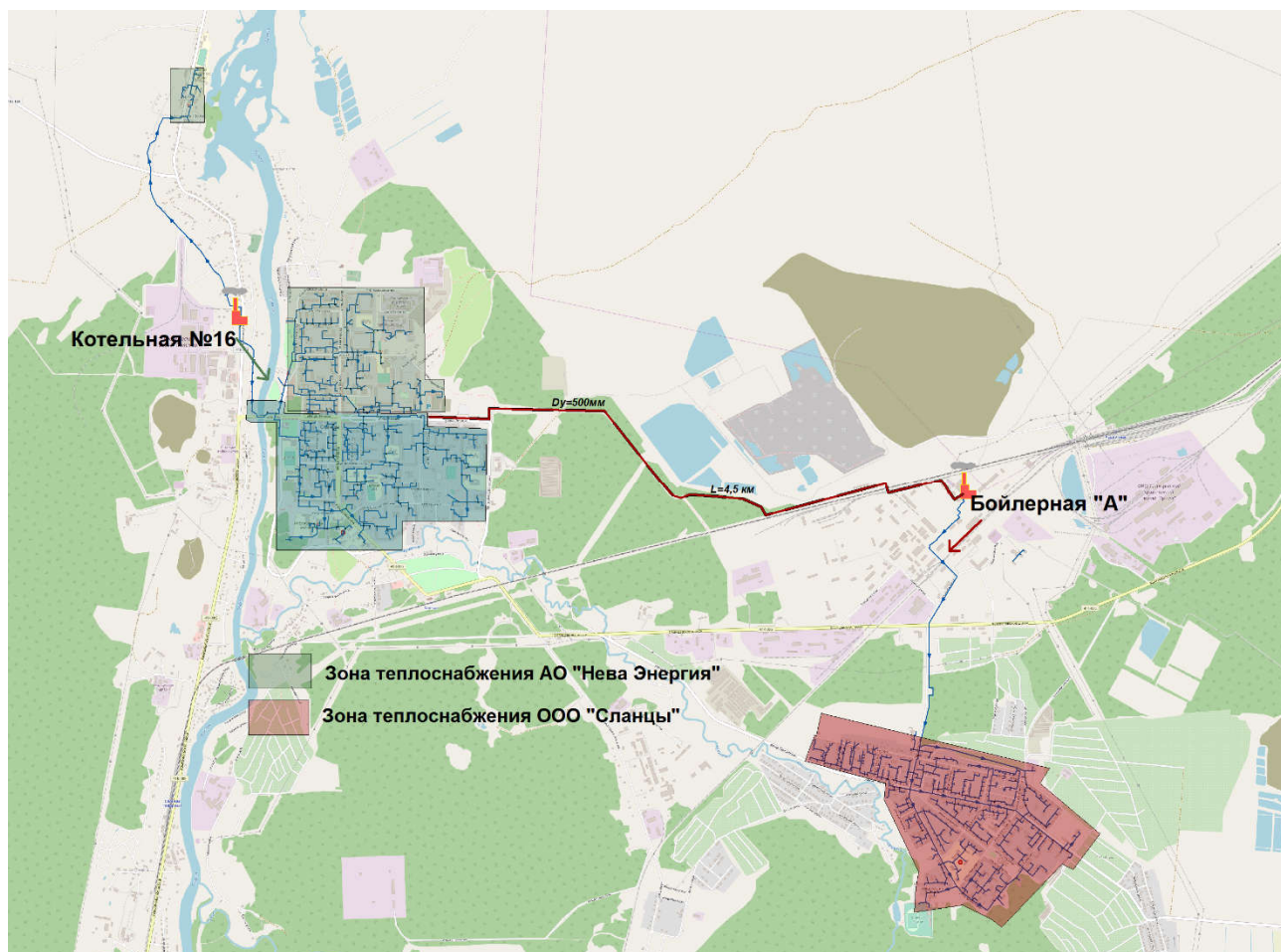
Рисунок 4.1.2 План-схема развития системы теплоснабжения по 2 варианту
