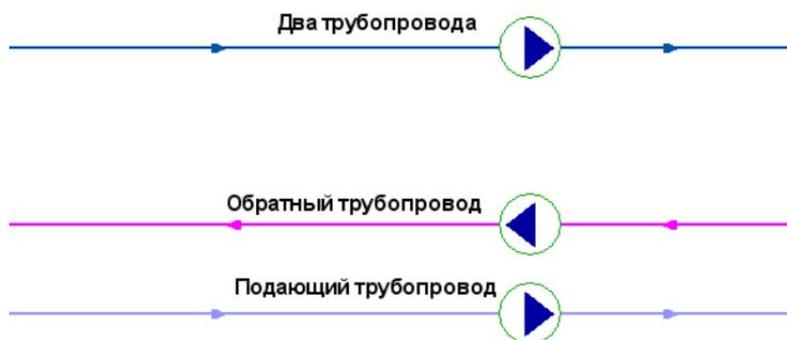
**Рисунок 35.** Сверху: однолинейное изображение, снизу – внутреннее представление.
