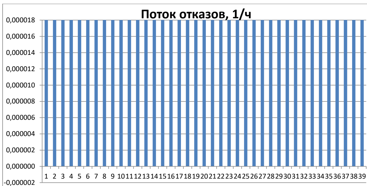
Рисунок 37 – Интенсивность отказов тепловых сетей от котельной № 16
