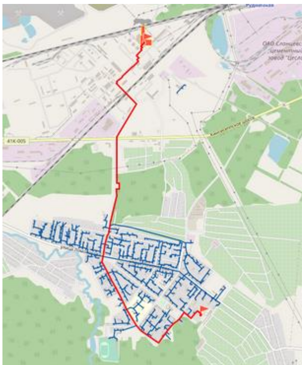
Рисунок 21 – Путь для построения пьезометрического графика от Бойлерной А ТЭЦ до дома инвалидов и престарелых по ул. Жуковского, 6В (Sys961)
