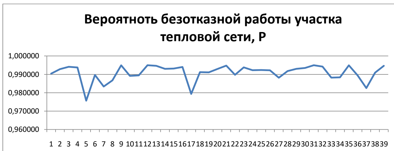
Рисунок 38 – Вероятность безотказной работы тепловых сетей от котельной № 16
